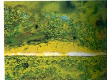
Fig. 15. Fotomicrografía de un corte transversal de la nariguera. La microestructura ocasionalmente presenta granos poligonales y equiaxiales en la zona más ancha del dorado. Aumentos: 1000. Reactivo químico: cloruro férrico alcohólico. Foto: S. Cutipa.
